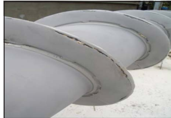
Superficie preparada para aplicación.
