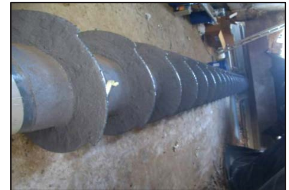
Tornillo de transporte reparado.
